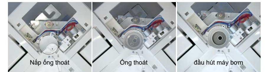
Tháo vỏ nắp thoát ra và kiểm tra. Nếu cần làm sạch, thì tháo nút cao su để thoát nước ra và tháo ống thoát nước ra. Dọn sạch khu vực xung quanh đầu hút máy bơm
